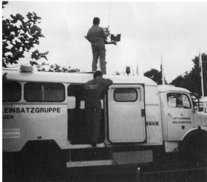
Der Lichtmast des Gerätewagens der SEG wird ausgerichtet. Das Fahrzeug verfügt zusätzlich über ein leistungsstarkes Aggregat zur Stromversorgung.
